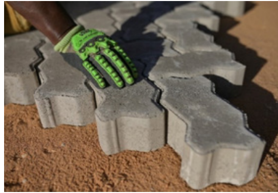
Blocos feitos de rejeito arenoso
