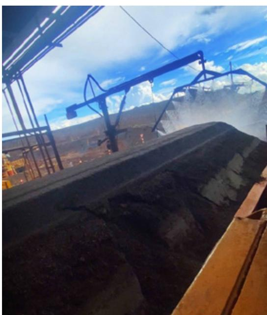
Supressor Sustentável sendo aplicado nos vagões dos trens de minério de ferro em Brucutu/MG
