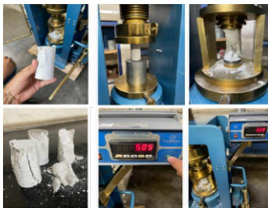
Ensaio preliminares de resistência à compressão.
