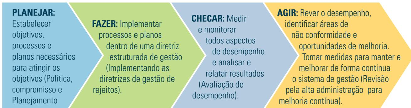
O ciclo é então repetido, com os objetivos revisitados e revisados conforme apropriado, e os processos e planos ajustados (veja a Figura 2). Isso ajuda a impulsionar a melhoria contínua, levando a melhorias de proteção ambientais e de redução de risco.
