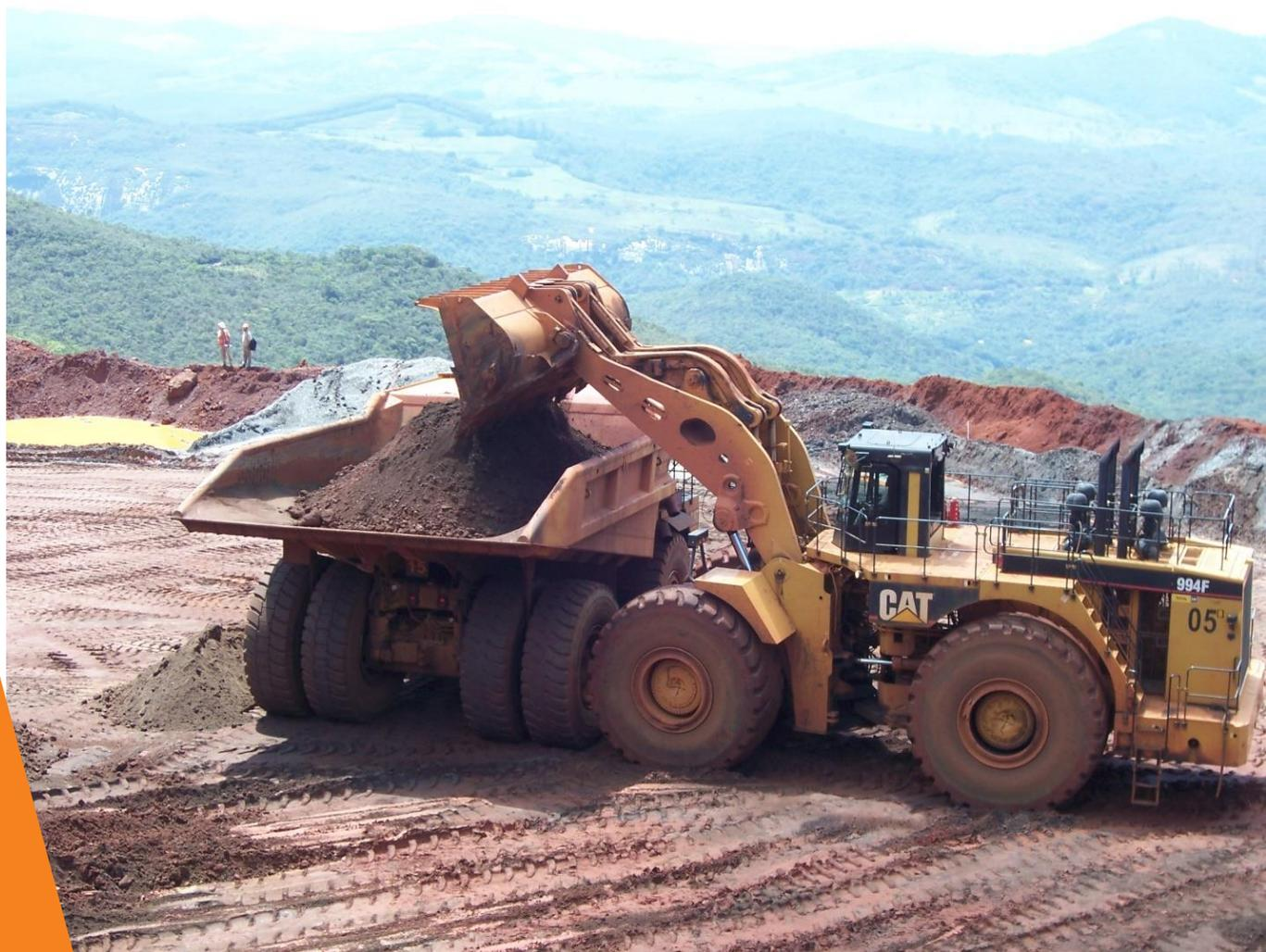
Operação de carregamento e transporte em caminhão fora-de-estrada em mina de ferro. Fonte: arquivo interno, 2006.
