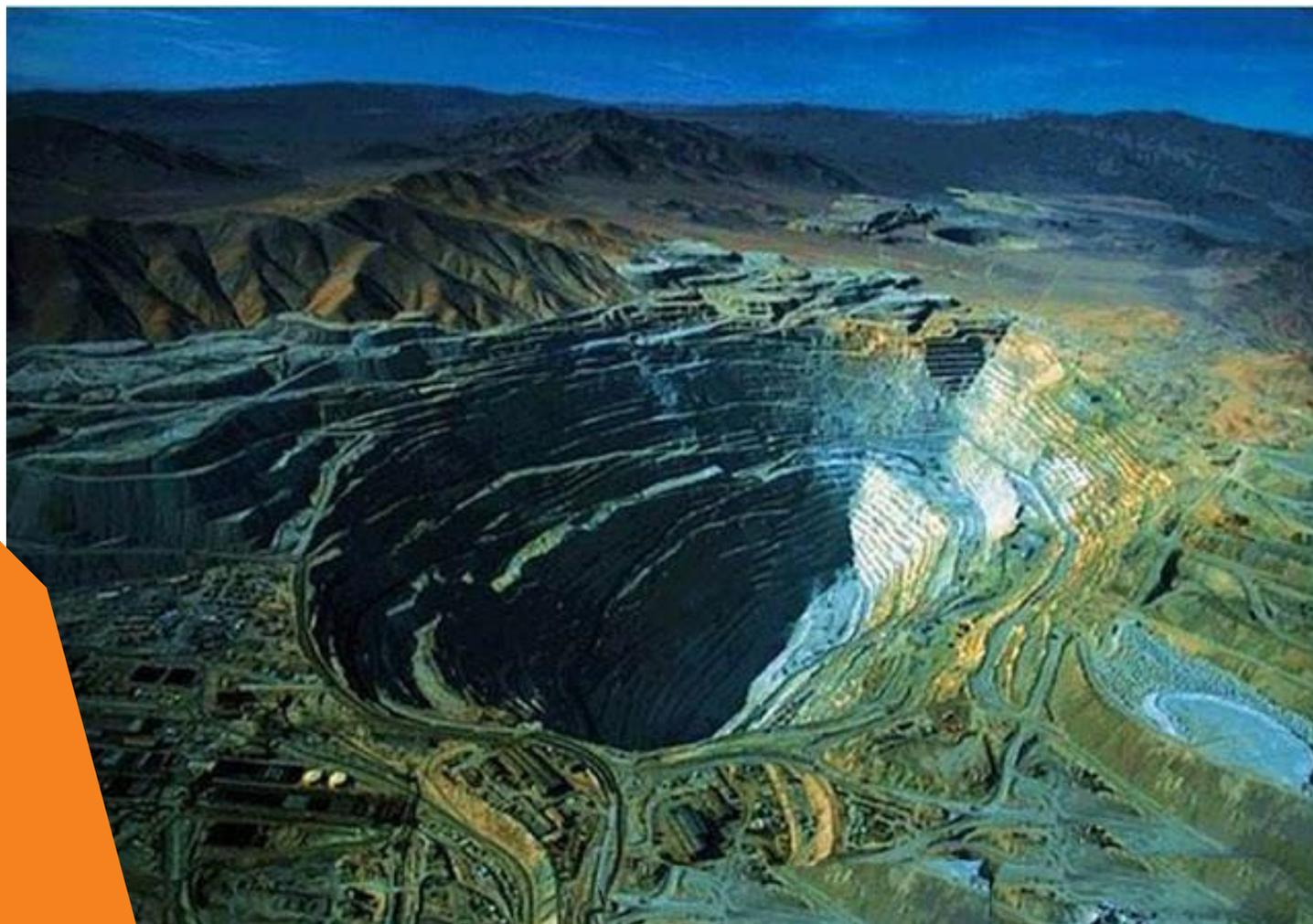
*Chuquibambilla, Codelco – Chile, Atacama – Cobre. Tem 6 quilômetros de comprimento, 4 de largura e uma profundidade de 850 metros.*
