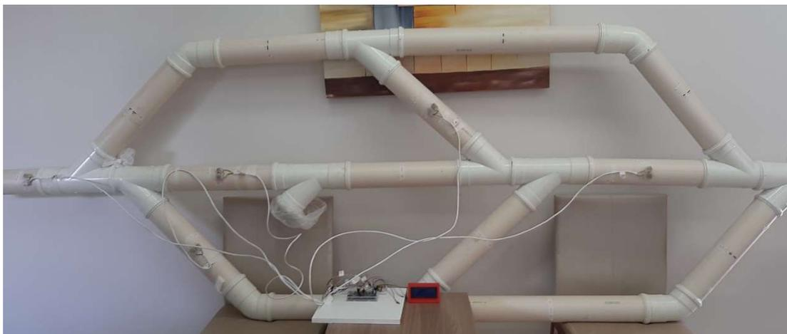
Figura 8 – Ligação dos sensores ao Arduino
