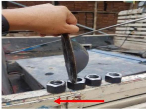
Figura 10 – “mesh plate” para travamento das telas eletrosoldadas.
