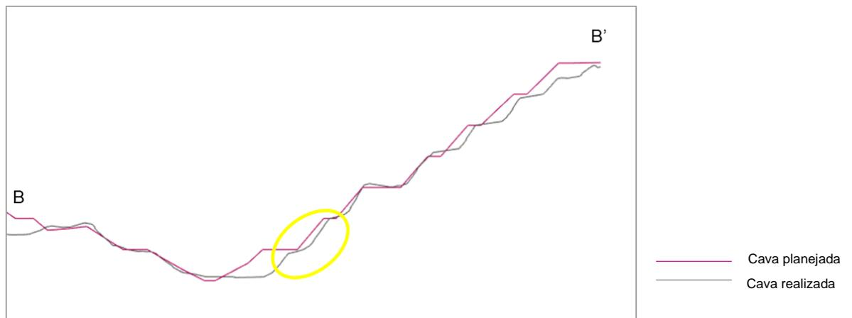
Figura11. Seção BB' - taludes com ângulos mais altos do que planejado e bermas estreitas (Fonte própria).
