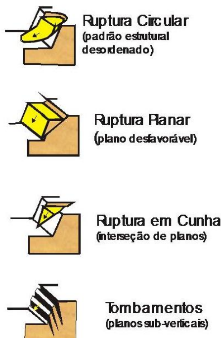
Figura 4: Mecanismo de ruptura mais comuns em mineração (SJOBERG,1996)
