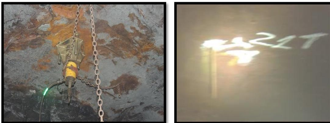
Figura 19 - Equipamento de teste de arranque e marcação em campo após teste realizado.
