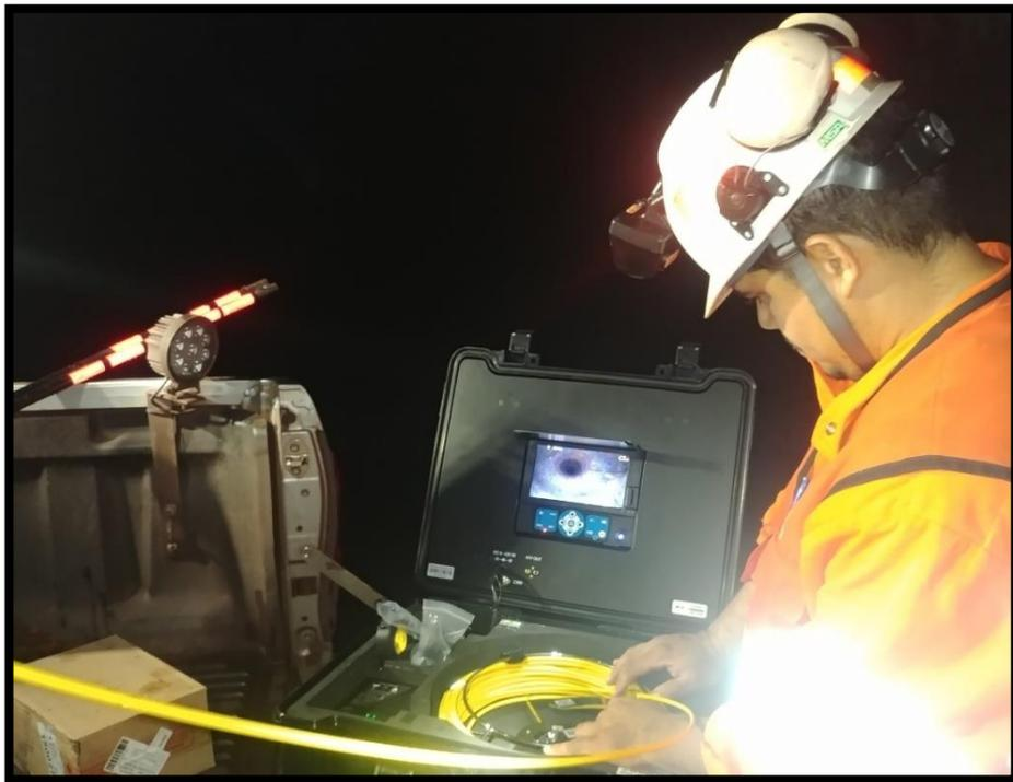
Figura 9 - Detalhe da imagem gerada conforme a introdução da câmera dentro do furo.
