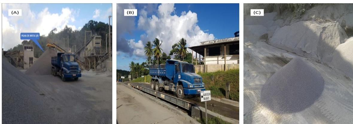
Figura 3: Ensaio para validação do uso de VANT para estimativa de massa: a) Caçamba sendo carregada com Brita 3/8". b) Caçamba sendo passada na balança rodoviária fixa. c)
