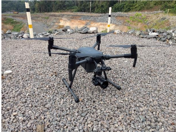
Figura 1: VANT industrial com câmera de alta resolução utilizado no sobrevoo da cava. (Fabricante: DJI)
