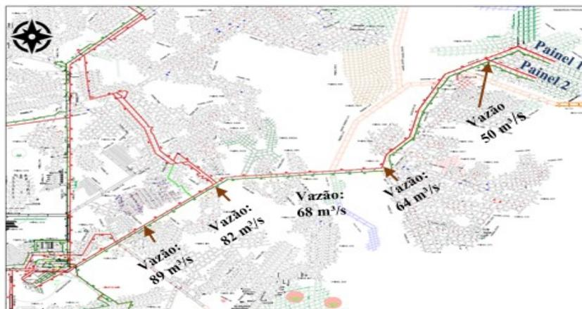
Figura 9- Vazão mínima para a área nordeste dos painéis 1 e 2.
