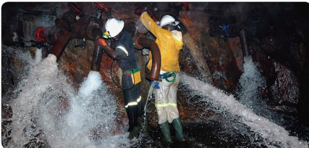
Foto 3. Drenagem mediante sondagens subhorizontais em frente de Galeria na Mina subterrânea de cobre da Konkola (Zambia), da Konkola Copper Mine
