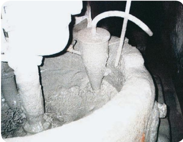
Foto 53. Tanque de bombeamento da lama abrasiva
