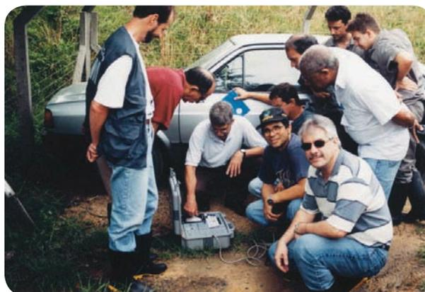
Foto 46: Medição sismográfica das detonações em treinamento promovido pelo DNPM
