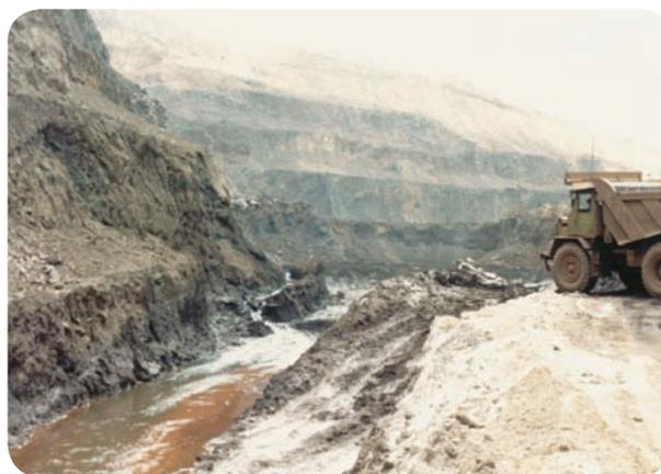
Foto 16. Abertura de trincheiras para drenagem e condução de água aos *sumps* da mina.
