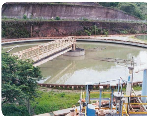
Foto 25. Espessador do rejeito de flotação em usina de beneficiamento de minério
