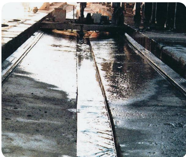
Foto 55. Canaleta para transporte da lama descartada num tear
