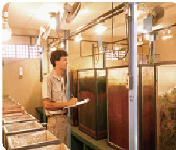
Foto 22. Laboratório de AMD com lisímetros na Rio Paracatu Mineração
