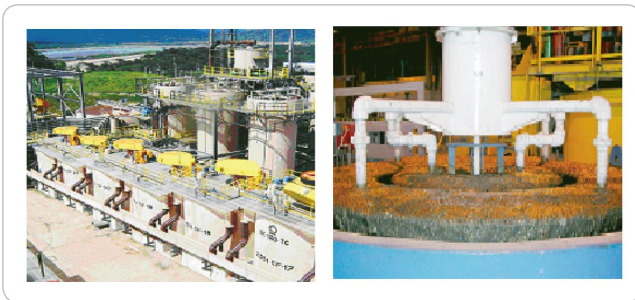
Foto 21. À direita, células de flotação mecânica e de coluna, com a visão da barragem de rejeito ao fundo e, à esquerda, uma visão da espuma na coluna de flotação, Usina/Mina de cobre do Sossego/CVRD
