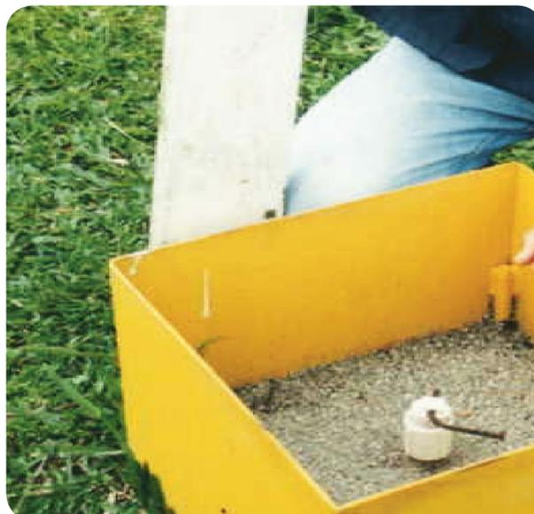
Foto 50: Detalhe dos poços piezométricos
