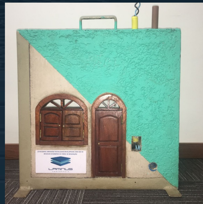
Foto protótipo de painel laminar utilizando o rejeito de mineração
