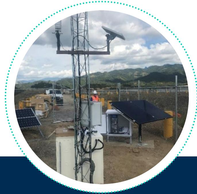
Instalada em dezembro de 2018, a solução consiste em 10 piezômetros, um sensor de altura ultrassônico e uma estação meteorológica, conectados pelo satélite da Inmarsat a um painel na nuvem.
