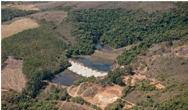
Vista aérea do conjunto de barragens, destacando-se, em tonalidade clara, ao centro, a barragem intermediária de enrocamento (agosto de 2011).
