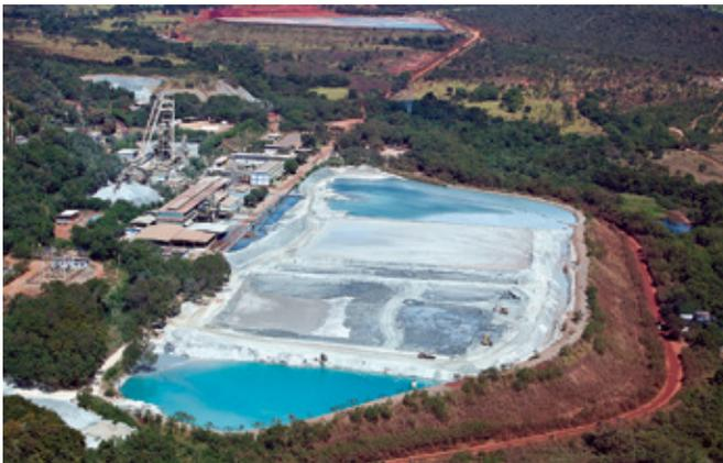
Vista geral das bacias de armazenamento de rejeitos, observando-se também as instalações industriais e o cavalete do poço de acesso à mina subterrânea.
