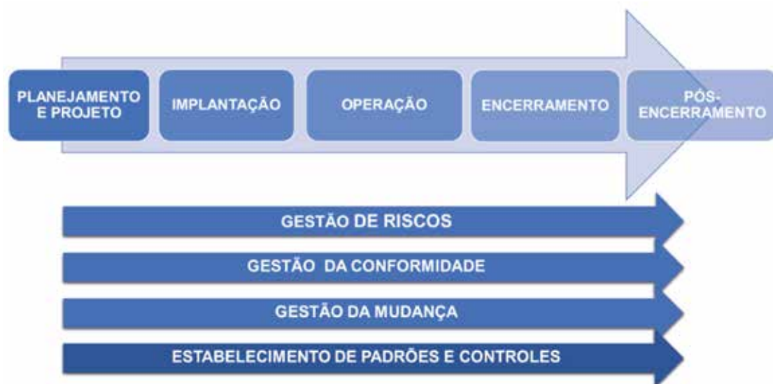
Figura 3.3 – Processos ao longo do ciclo de vida de barragens e estruturas de disposição de rejeitos.
