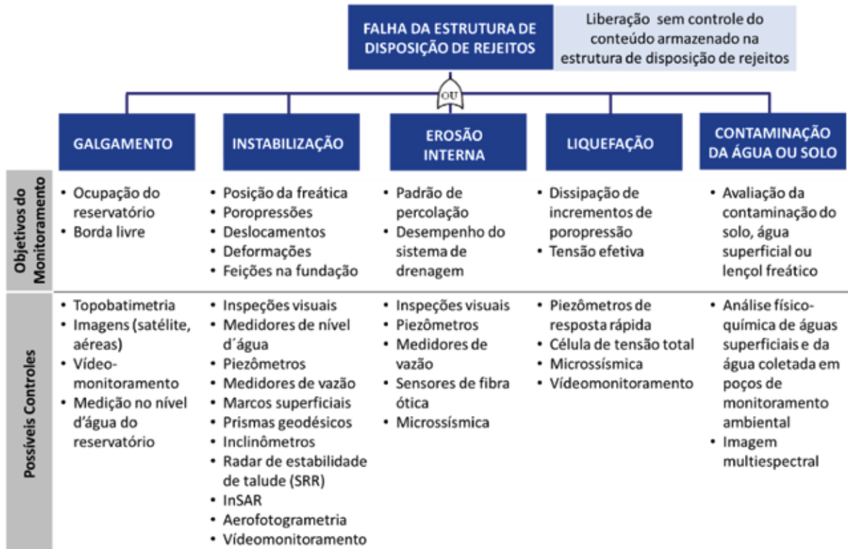
Figura 4.2 – Monitoramento de estruturas de disposição de rejeitos (adaptado de Safety Management of Geotechnical Structures , 2018).
