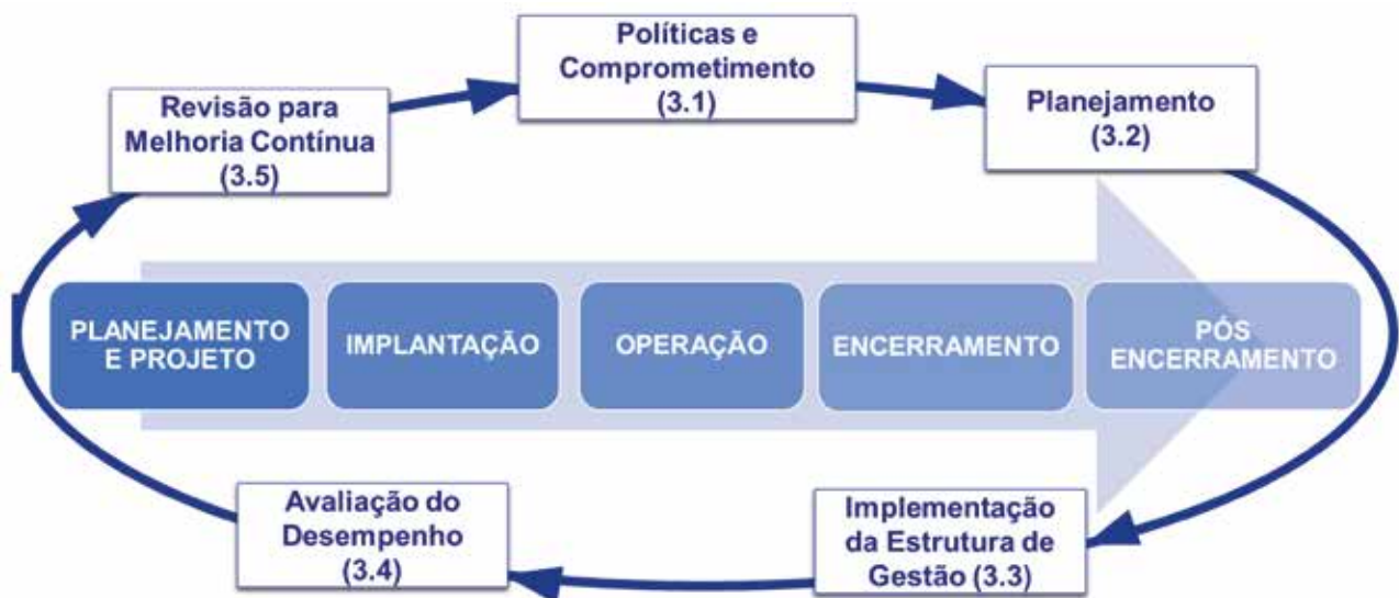
Figura 3.1 – Elementos de um Sistema de Gestão de Barragens e Estruturas de Disposição de Rejeitos.
