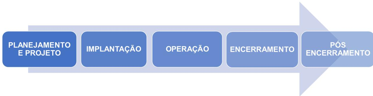
Figura 1.1 – Etapas do Ciclo de Vida de Barragens e Estruturas de Disposição de Rejeitos.
