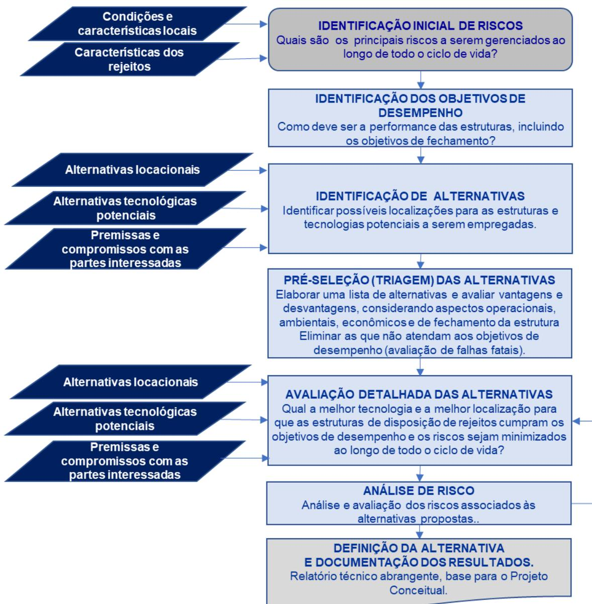
Figura 4.1 – Processo de seleção de alternativas para sistemas de disposição de rejeitos (adaptado de MAC, 2017).
